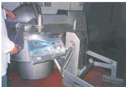
**Cutter. Máquina que interviene en el proceso de picado, mezclado y condimentación de la carne.**
